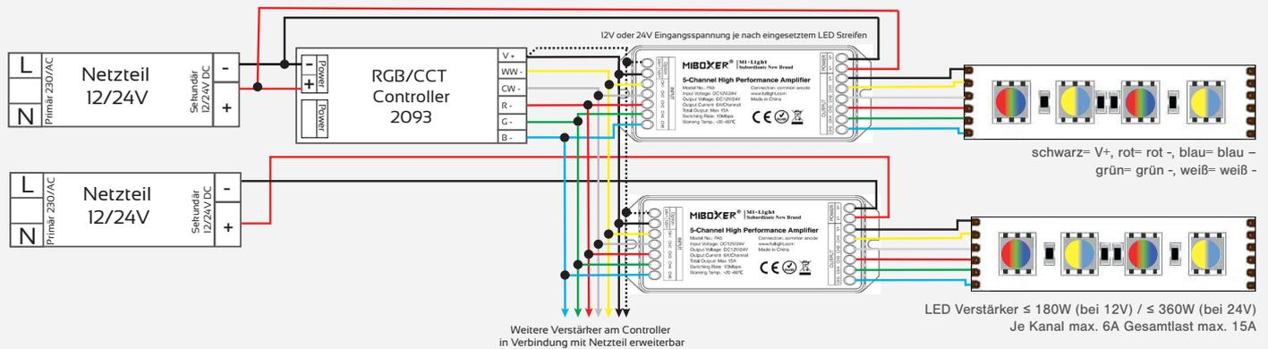
Kabelbelegung einfarbiger LED Streifen
